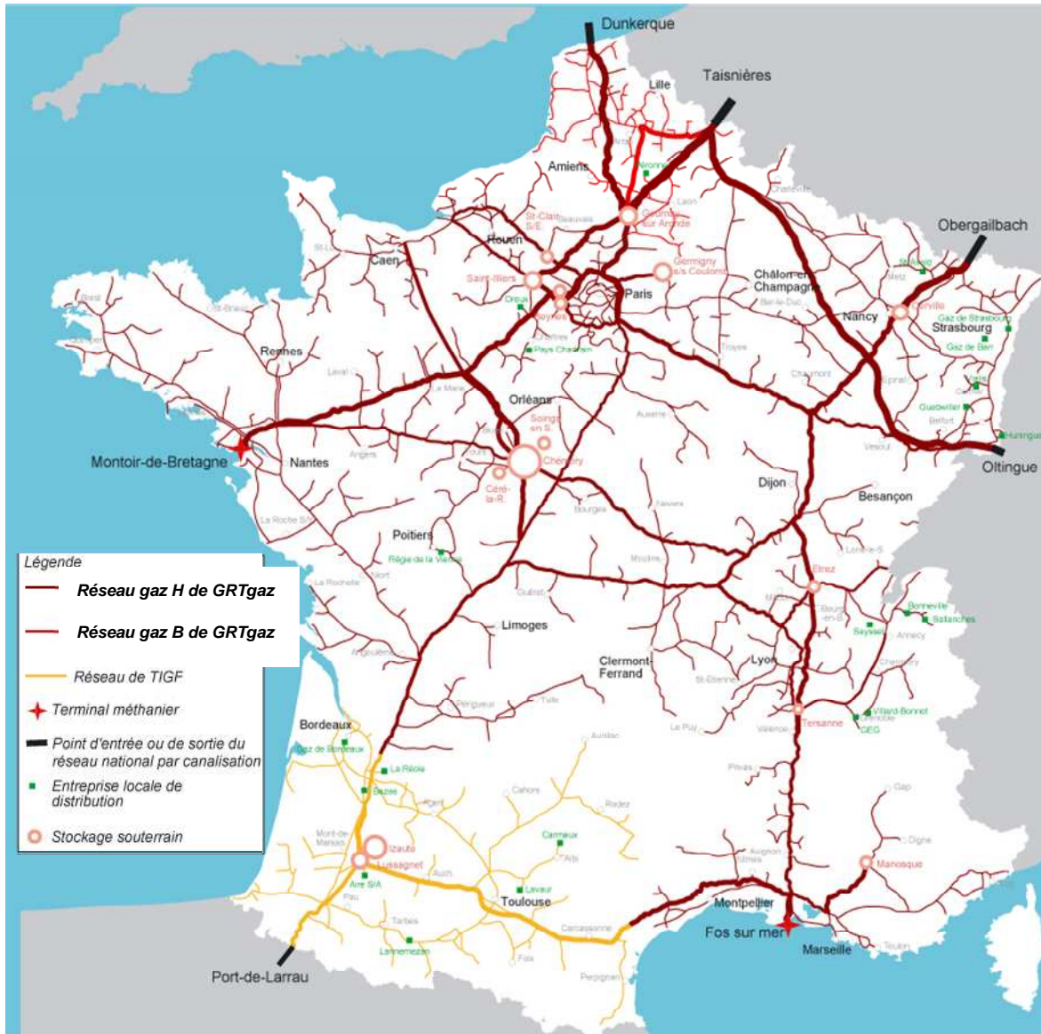
FIGURE N° 13 : RESEAUX DE GAZ NATUREL, TERMINAUX METHANIER, STOCKAGES SOUTERRAINS ET ENTREPRISES LOCALES DE DISTRIBUTIONS
